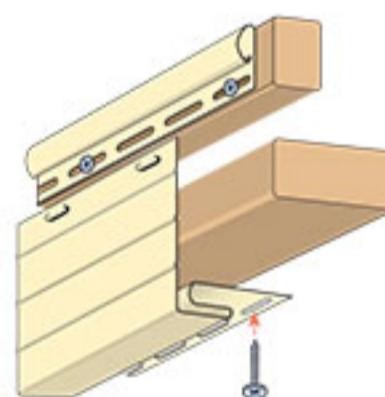
Горизонтальные J-фаски устанавливают по правилам крепления горизонтальных элементов, наклонные J-фаски крепят по правилам установки вертикальных элементов. К верхней кромке ветровой доски крепится финишный профиль. Фаска защелкивается в финишную планку на «зачепы». При необходимости удлинить J-фаску элементы закрепляются внахлест на величину 25 мм.
