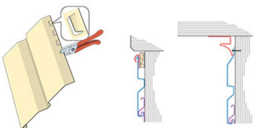
Монтаж панелей заканчивается в финишном профиле или молдинге, для чего необходимо сделать «зачепы» в верхней части панели для установки в финишный профиль, или закрепить сайдинг через дополнительное гвоздевое отверстие, которое необходимо закрыть молдингом.
