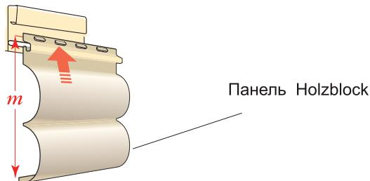
Измерить расстояние  $m$  (от замка до дна желоба подкарнизного профиля минус 3 мм), перенести это расстояние на цельную панель Holzblock. Отрезать ее по длине. Сделать на ней зацепы и установить панель Holzblock, с защелкиванием нижнего замка.
