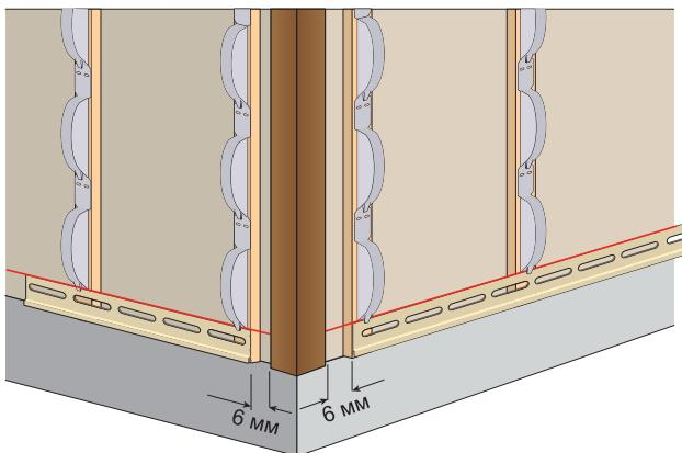
Начальная полоса Holzblock применяется для крепления первого ряда панелей. Она крепится к обрешетке саморезами по центру отверстий с зазором 1 мм для температурного расширения.
