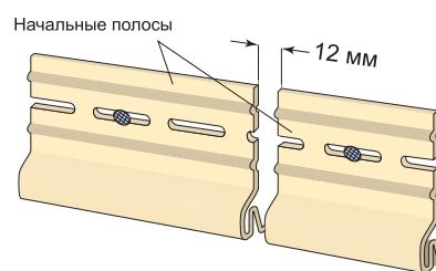
При установке начальных полос оставляйте между ними зазор 12 мм.
