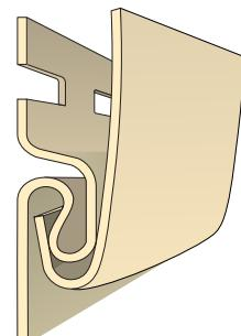
Не затягивайте саморезы вплотную к панели. Оставляйте зазор примерно 1 мм между головкой крепежа и панелью Holzblock . Панель должна быть закреплена, но не затянута. При монтаже вводите крючок замка в ответную часть без натяжения панели.
