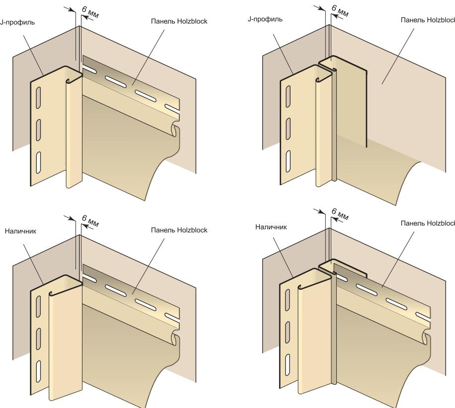
Для оформления внутреннего угла используется j-профиль или наличник Holzblock, поскольку в составе фасадной системы внутренние углы отсутствуют. J-профиль является универсальным элементом системы и позволяет оформить абсолютно любой угол.
