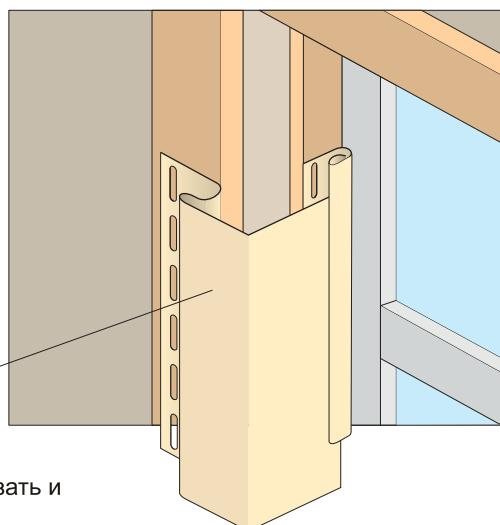
В верхнем и нижнем околооконном профиле в полках откосов надрезать и отогнуть
