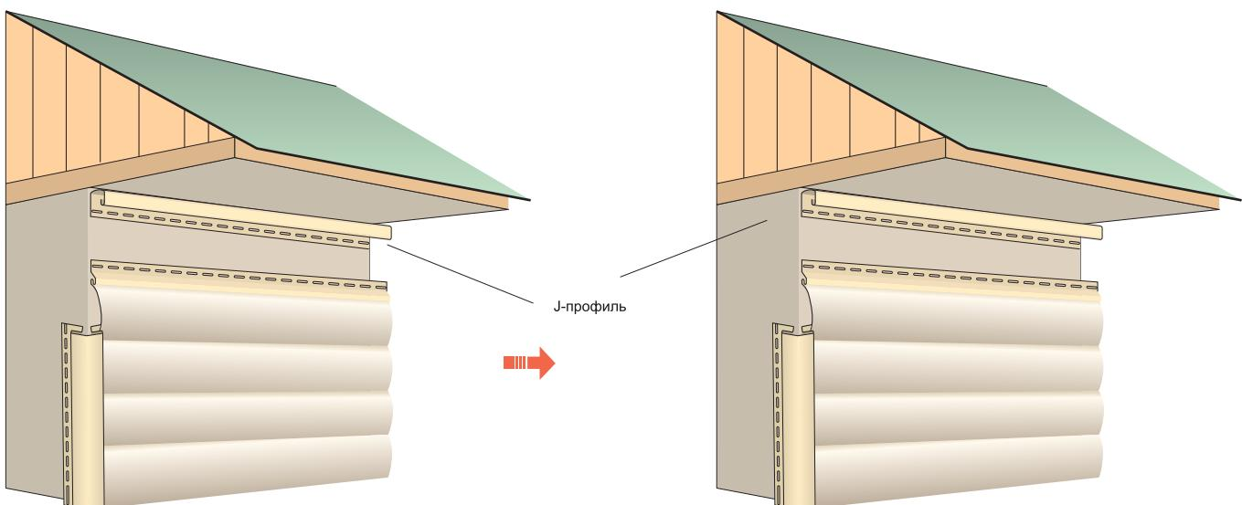
Установить под карнизом систему из J-профиля или наличников. После разметки и обрезки панели Holzblock закончить обшивку.
