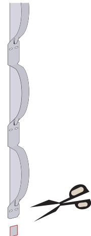
При установке первого крепежного профиля язычок отрезается, для того чтобы обеспечить примыкание к отливу.
