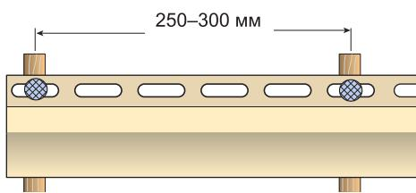
Устанавливайте крепеж по центру отверстий. Один неверно установленный саморез может остановить температурное расширение и панель покоробится. Первый саморез вертикальной панели ставится к краю отверстия, остальные по центру.
