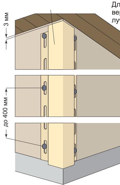
Длястыкования двух угловых профилей по длине, подрежьте верхний профиль так, чтобы между гвоздевыми планками получился зазор 9 мм, а нахлест профилей — 25 мм
