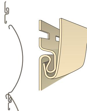
Первая панель Holzblock защелкивается в стартовую полосу, устанавливается в крепежный профиль, заводится за аксессуары. При креплении, панель не должна вплотную подходить к аксессуарам – расстояние 6 мм.
