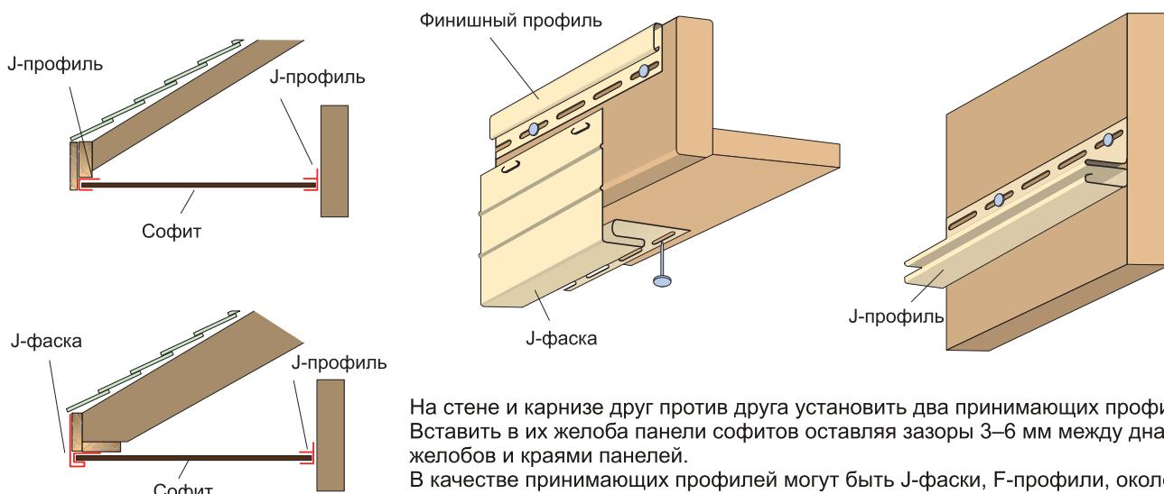
На стене и карнизе друг против друга установить два принимающих профиля. Вставить в их желоба панели софитов оставляя зазоры 3–6 мм между днами желобов и краями панелей.
