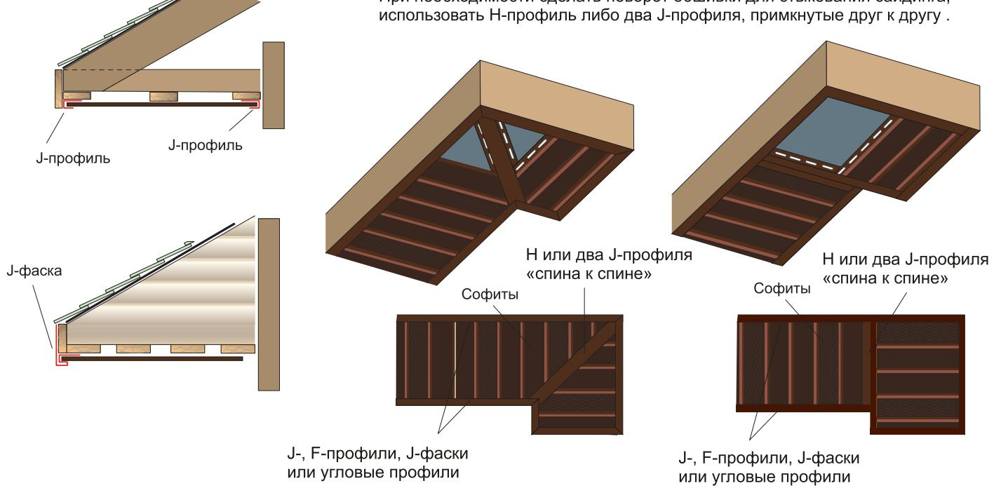
Используя уровень, сделайте на стене метки, параллельные нижнему краю карниза, далее вдоль меток прикрепите принимающие профили. Отмерьте расстояние между днами желобов принимающих профилей, Вычтите 6 мм для возможного расширения-скатия. Отрежьте софит по этой длине и установите его. Закрепите каждую панель по центру перфорационного отверстия.
