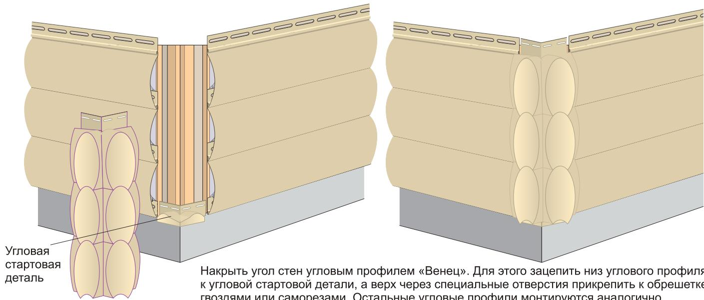
Накрыть угол стен угловым профилем «Венец». Для этого зацепить низ углового профиля к угловой стартовой детали, а верх через специальные отверстия прикрепить к обрешетке гвоздями или саморезами. Остальные угловые профили монтируются аналогично.
