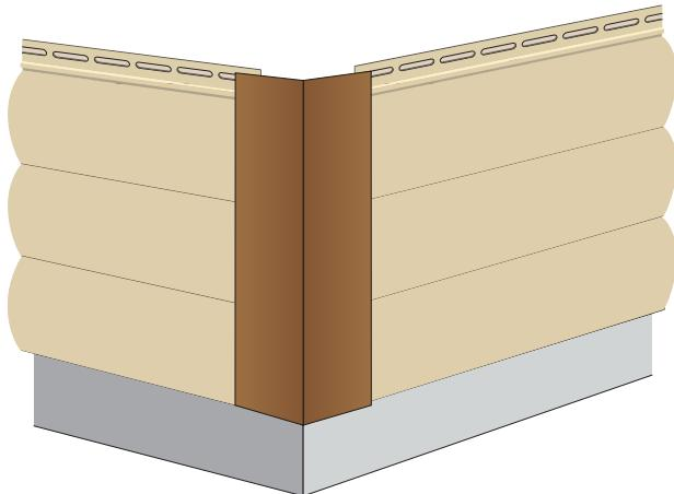
При установке следующей фасадной панели Holzblock низ панели цепляется за первую установленную панель, а верх защелкивается за крючок крепежного профиля.
