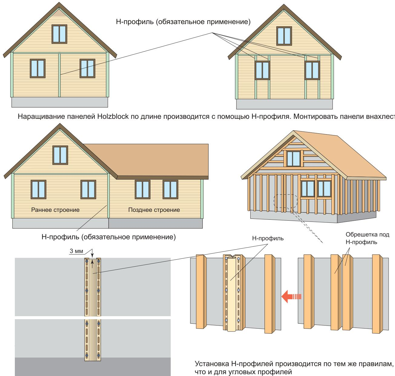
Увеличение длины Н-профиля производится путемстыкования внахлест. Стыкование конструктивно напоминаетстыкование двух угловых профилей — верхний профиль нахлестывается на нижний. Размещение Н-профиля на стене должно быть продумано заранее, чтобы вертикальный разрез рядовых панелей, визуально подчеркнутый Н-профилем, органично вписывался в общую картину обшивки.
