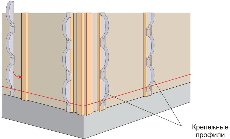
**ВАЖНО:** профиль крепится на обрешетку с шагом в 40 см, что обеспечивает жесткость всей конструкции. Расход крепежных профилей на 1 м.кв. составляет 4 шт.
