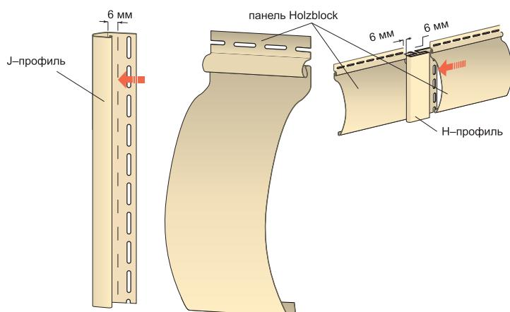
При вводе панели Holzblock в примыкающий профиль оставляйте зазор 6–9 мм между торцом панели и желобом примыкающего профиля.
