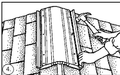
4. Начиная от края крыши, прикрепите первый элемент к сплошному основанию гвоздями, через специальные технологические отверстия. Убедившись, что фильтр находится по центру вентиляционного канала, последовательно прибейте оставшиеся секции.
