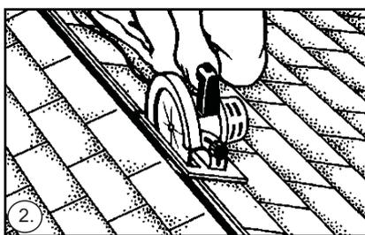
2. Выпилите отверстие в сплошном основании крыши. Избегайте повреждения стропил и ферм крыши (см. Рис. 7, 8, 9, 10). Освободите отверстие от мусора (см. п.7 настоящей инструкции).
