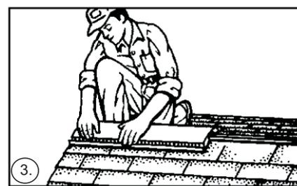
3. Распределите элементы вентиляции по коньку крыши, непосредственно над выпиленным каналом. Убедитесь в том, что фильтр надежно закреплен, а опорные ребра элементов равномерно и плотно примыкают к кровле (см. п. 9 настоящей инструкции).
