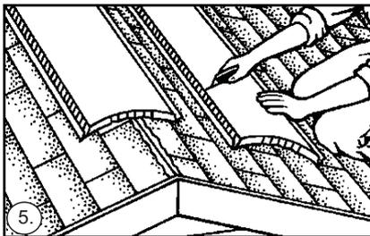
5. Отрежьте последнюю секцию под нужную длину. Закрепите последнюю секцию не резанной стороной так, что бы она располагалась на одном уровне с краем крыши.
