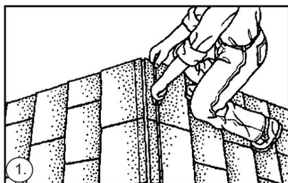
1. Удалите коньковую черепицу (см. п.7 настоящей инструкции). Используя разметочный шнур и карандаш (мел). Произведите разметку вентиляционного канала (см. Рис.7, 8, 9).
